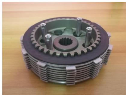
Nun ist es wichtig eine ruhige Hand zu haben. Sie müssen die Federn, die Kern und Nabe fixiert haben nun lösen. Versuchen Sie dabei nicht so viel zu wackeln, da sonst die Kugeln aus den Führungen fallen und gegebenenfalls die Kupplung bei der weiteren Montage beschädigt wird.
