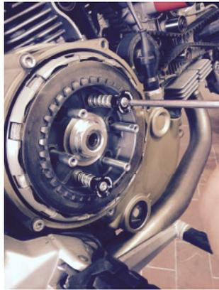
Legen Sie nun die kleinen Unterlegscheiben auf die Kupplungsbolzen. Die kleinen Hilfsfedern erst danach.
