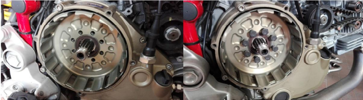
Ziehen Sie die acht Schrauben mit einem Drehmomentenschlüssel fest (32 NM!)
