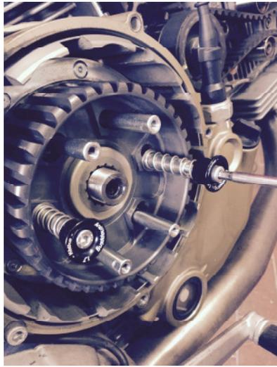
Legen Sie die Unterlegscheibe auf den Kurbelwellenstumpf und montieren Sie dann die passende Mutter mit Schraubensicherung.
