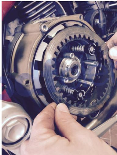
Legen Sie danach wieder eine Reibscheibe ein. Führen Sie das ganze abwechselnd fort bis keine Reibscheibe mehr übrig ist und am Ende eine (oder zwei) Stahlscheibe bleibt. Wichtig ist, dass alle Stahlscheiben, die Sie montiert haben die gleiche Dicke besitzen. Die dünne Stahlscheibe legen Sie sich beiseite.
