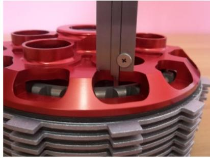
Dies führt man am Besten mit einem Messschieber aus. Bitte beachten Sie, dass die Druckplatte komplett an der letzten Stahlscheibe anliegt!
