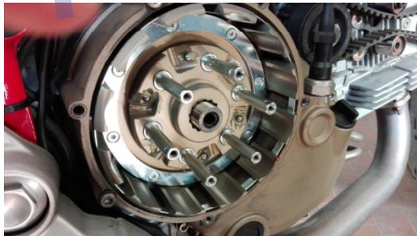
So wie auf den Bildern zu sehen, hätten die Stahlkugeln keinen Halt. Bitte setzen Sie an zwei gegenüberliegenden Bolzen jeweils eine Feder an, um den Kern an die Nabe zu drücken.
