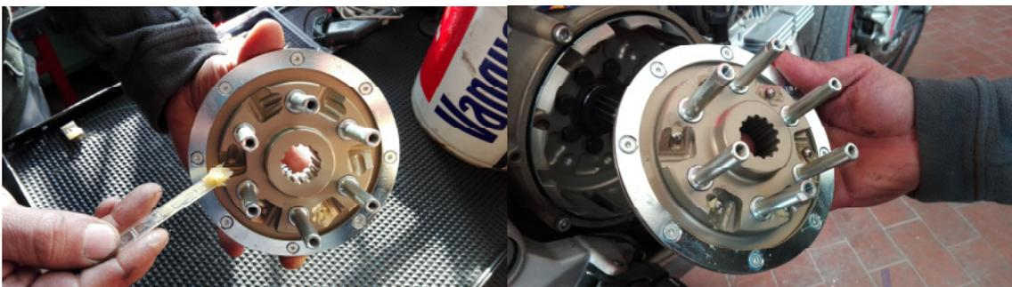
Wir empfehlen die Kupplungsnahe und den Kupplungskern vor dem Einsetzen in den Motordeckel mit Hilfe von zwei Kupplungsfedern und zwei Schrauben gegenüberliegend zusammen zu bauen und zu fixieren. So können die Kugeln während dem Einsetzen nicht herausfallen.
